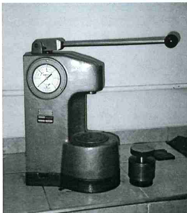
Figura 10: Prensa utilizada para confecção das pastilhas.
