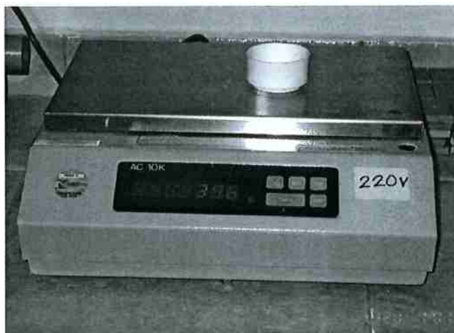
Figura 11: Balança utilizada para medir a massa das pastilhas.
